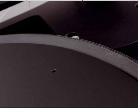
Gummilippen besorgen die Abdichtung, über Bohrungen im Teller wird die Luft abgesaugt
